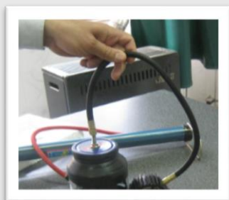
شکل ۵: بالا بردن فشار با کمک پمپ
