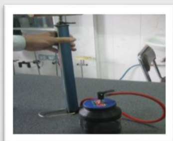
شکل ۵: بالا بردن فشار با کمک پمپ
